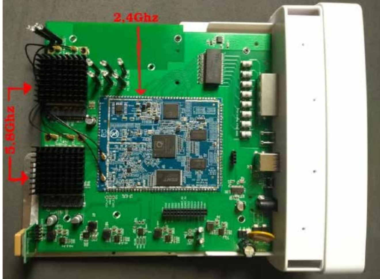
Figura 33 Placa interna da versão do LibreRouter distribuída em 2019. Fonte: Altermundi
